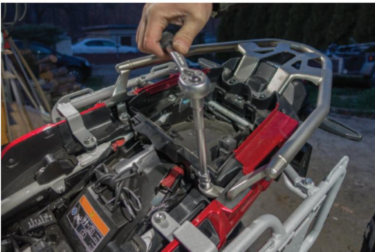
**22. Ziehen Sie anschließend alle Schrauben und Muttern an. Achten Sie darauf, dass Sie nach einer Probefahrt alle Schrauben und Muttern noch einmal überprüfen.**
