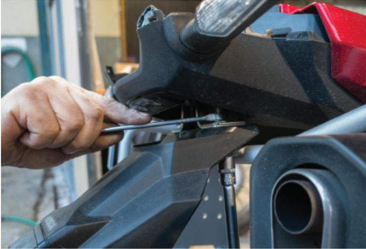
16. Setzen Sie die obere mittlere Schraube, die Sie in Schritt #7 entfernt haben, wieder ein. Ziehen Sie sie fest.
