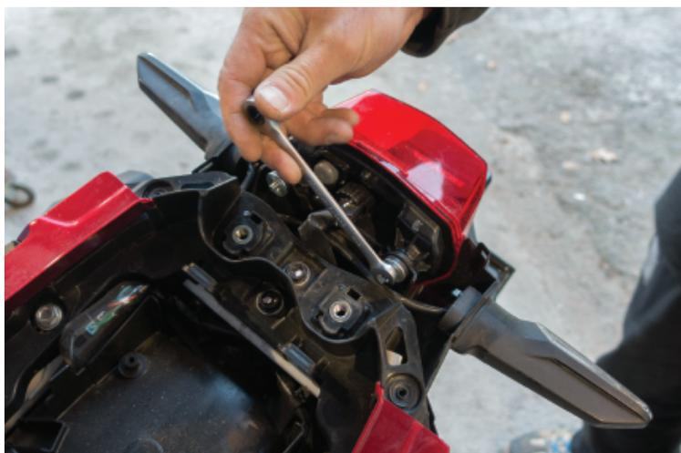
6. Entfernen Sie mit einem 5-mm-Inbusschlüssel die beiden Inbusschrauben bei den hinteren Blinkleuchten.
