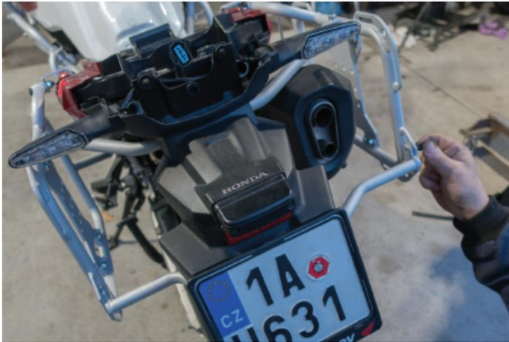
20. Montieren Sie die hintere Bremsleuchte und die Kunststoffabdeckung wieder.
