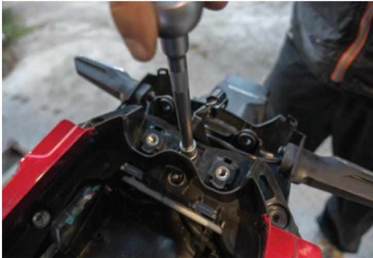
8. Entfernen Sie beide Schrauben unter dem hinteren Kotflügel mit einem 12-mm-Steckschlüssel und Ratsche.
