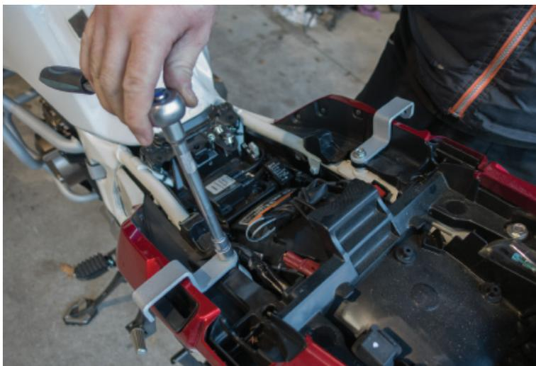
10. Entfernen Sie die Fußraste auf der rechten Beifahrerseite. Fügen Sie zwischen der vorderen Lasche und dem Hilfsrahmen den mitgelieferten Abstandshalter ein.
