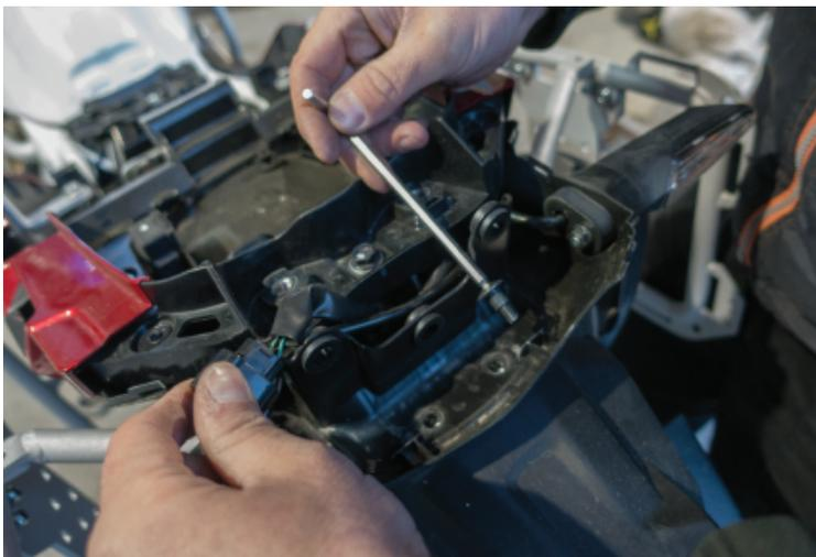
18. Setzen Sie die mitgelieferten 6-x-20-mm-Schrauben ein, fügen Sie die Sicherungsmuttern hinzu, lassen Sie sie aber auf beiden Seiten lose.
