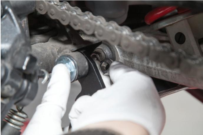
8. Ziehen Sie die Schraube und die Mutter mit zwei 17-mm-Schraubenschlüsseln an.
