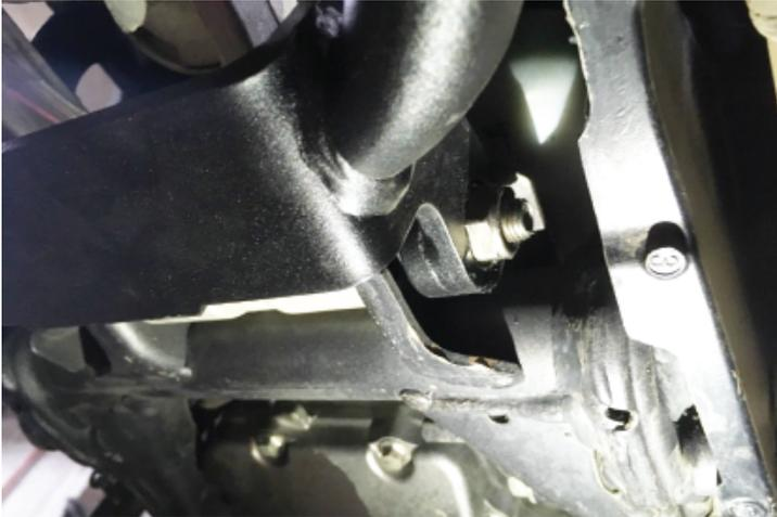
4. Nachdem das rechte Montageloch befestigt wurde, richten Sie das linke Loch mit dem entsprechenden Montageloch aus.
