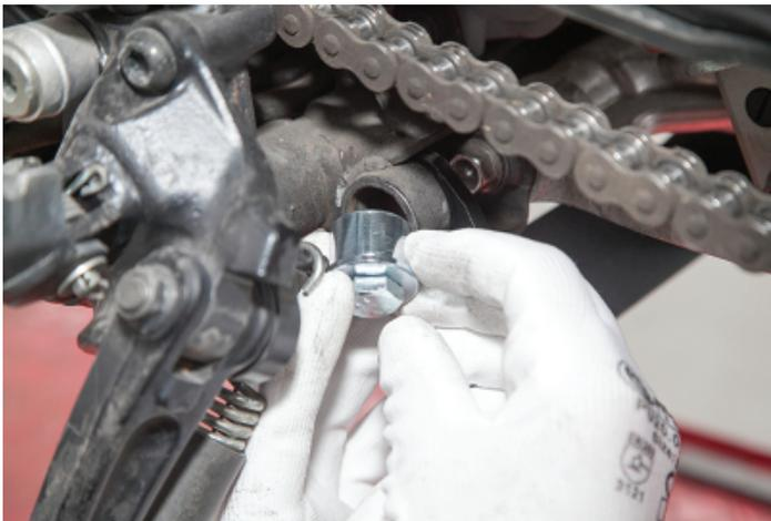
6. Drücken Sie die mitgelieferte Sechskantschraube mit 10-mm-Durchmesser mit der Unterlegscheibe durch.
