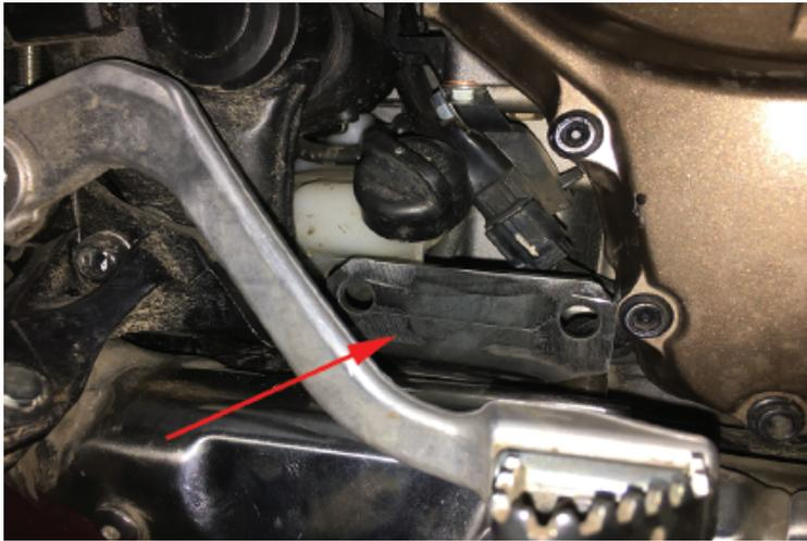
8. Mit der hinteren Halterung welche nun angebracht ist, können Sie von Hand beginnen die Muttern (Teile Nr. 7) auf der vorderen Schachtschraube festzuziehen.
