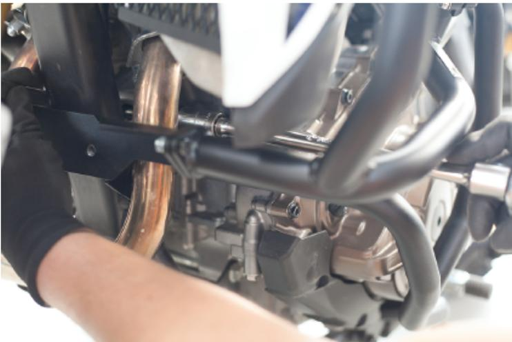
14. Wiederholen Sie dasselbe mit der unteren Schraube und benutzen Sie eine 13mm Stecknuss und einen Ringschlüssel.
