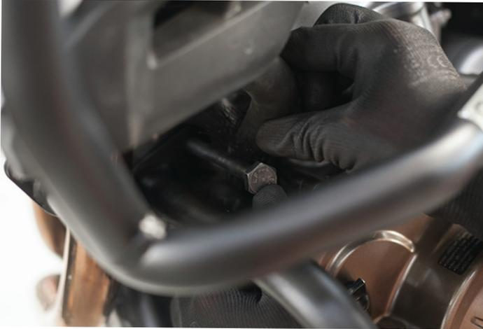
4. Installieren Sie das Gegenstück der Klammer auf dem Verstärkungsrohr. Bringen Sie die beiden Rundkopf-Imbuss-Schrauben an. Bringen Sie die Unterlegscheiben an und schrauben Sie die Stopmmutter von Hand fest.
