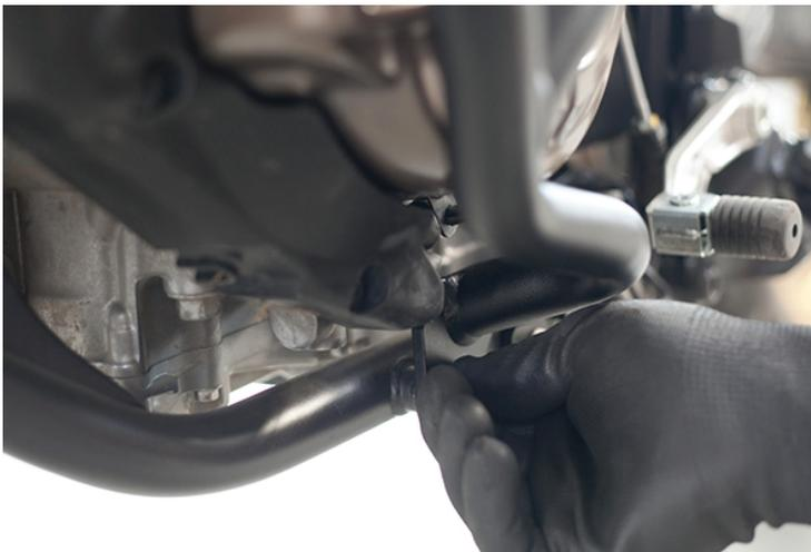
6. Gehen Sie auf die rechte Seite (Auspuffseite) Ihrer Africa Twin. Schauen Sie unter das Motorrad. Dort befinden sich zwei Schaftschrauben die durch den Rahmen fixiert sind. Mit zwei 14mm Ringschlüsseln entfernen Sie jeweils nur die beiden Muttern. Die Schrauben müssen NICHT entfernt
