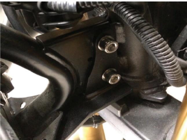
6. Montieren Sie den linken Sturzbügel.
