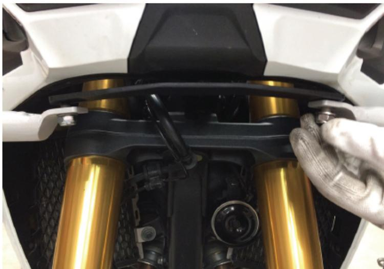
10. Zum Schluss ziehen Sie alle Schrauben und Muttern nach den Drehmoment-spezifikationen an und überprüfen sie nach einer Probefahrt erneut.
