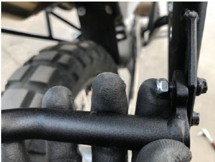
10. Ziehen Sie alle vier Muttern mit zwei 10mm Schraubenschlüsseln und/oder 10mm Steckschlüssel und Ratsche an.
