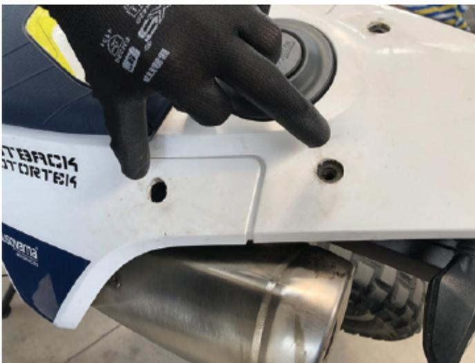
2. Entfernen Sie den linken werkseitigen Fußrasten mit einem Torx 35-Steckschlüssel und einem Schraubenschlüssel.
