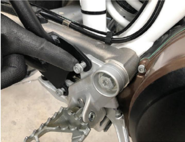
8. Montieren Sie die hintere Querstrebe. Achten Sie darauf, dass die Laschen der Querstrebe zwischen den Laschen der Kofferrahmen enden.
