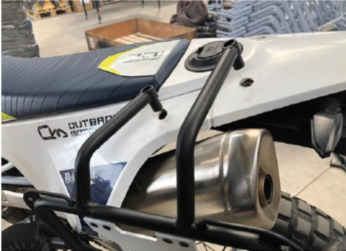
4. Setzen Sie die mitgelieferten Schrauben M8x45mm ein. Ziehen Sie die Schrauben mit nur ein oder zwei Umdrehungen fest, damit die Schrauben locker bleiben.
