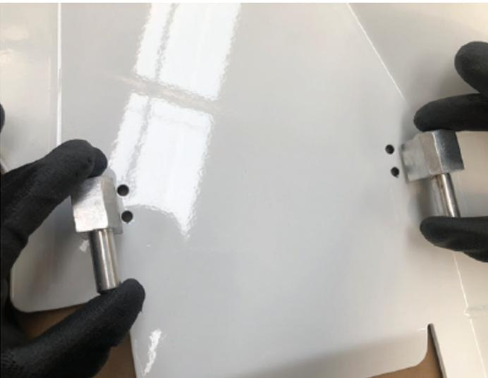
6. Schrauben Sie die mitgelieferten M6-Inbusschrauben händisch durch den Boden.
