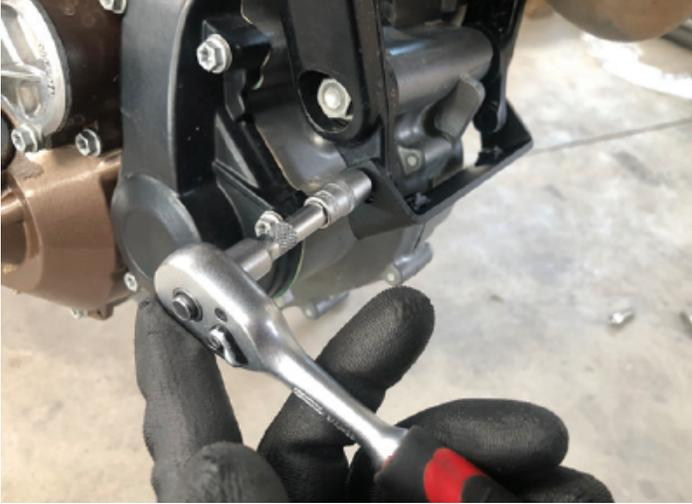
4. Vergewissern Sie sich, dass die Halterung locker genug ist, um die Befestigungslöcher an der Halterung mit dem Motorschutz auszurichten.
