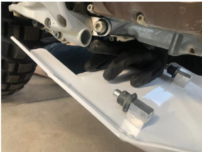
10. Drehen Sie die mitgelieferten M6-Sechskant-/Torxschrauben per Hand ein, nachdem Sie die Befestigungslöcher auf dem Motorschutz und der Halterung ausgerichtet haben. Ziehen Sie die Schrauben mit einem 10-mm-Steck- oder Schrauben- oder Torxschlüssel fest.
