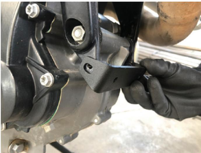
2. Befestigen Sie sie an den Befestigungspunkten des Rahmens, indem Sie die mitgelieferten Sechskantschrauben an beiden Seiten per Hand anschrauben.
