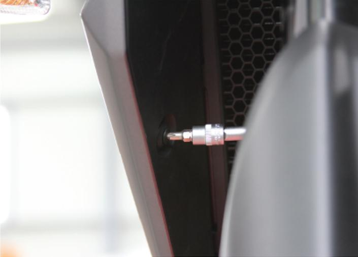
4. Entfernen Sie die oberen Schrauben mit einem 5-mm-Inbusschlüssel sowohl von der rechten als auch von der linken Seite.
