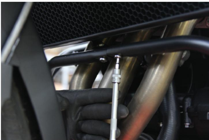
10. Beginnen Sie auf der rechten Seite mit dem Entfernen der Motor-Durchgangsschraube. Erforderliches Werkzeug: zwei Ratschen, eine kurze und eine sehr lange Verlängerung (12" oder 30 cm), M8-Inbussteckschlüssel (XC/ XR), T50-Torx-Steckschlüssel (XCX/ XRX) und ein Kreuzgelenk.
