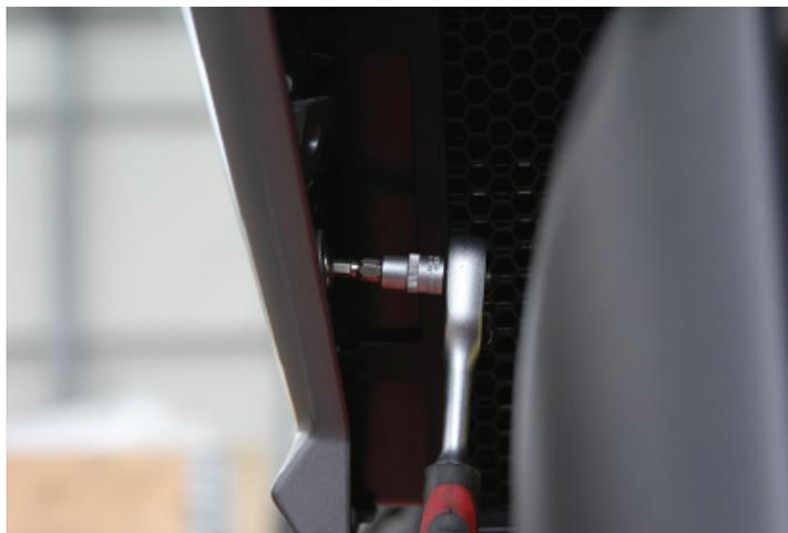
6. Fahren Sie mit dem 5-mm-Inbusschlüssel fort, um die Inbusschraube zu entfernen, die sich an der Außenseite der Kunststoffverkleidung befindet. Wiederholen Sie dies auch auf der linken Seite.
