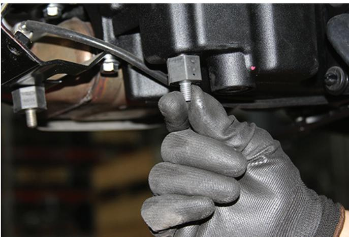
2. Montieren Sie die hintere Montagehalterung (#2) mit den beiden Stopmmuttern und Unterlegscheiben an den werkseitigen Gummilagern. Ziehen Sie beide mit einem 13-mm-Steckschlüssel und einer Ratsche fest. Tipp: Achten Sie darauf, dass Sie das unter dem Motor verlaufende Kabel nicht einklemmen. Legen Sie es in die Nut.
