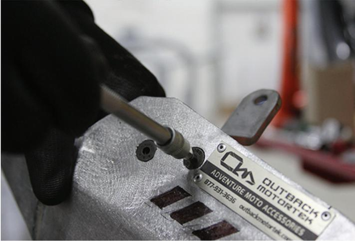
4. Bevor Sie den Motorschutz montieren, entfernen Sie bitte (falls vorhanden) die Befestigungsschrauben des vorderen Motorschutzes auf beiden Seiten. Das Lösen von mehr Schrauben für Motorschutz und Sturzbügel hilft Ihnen bei der Montage der Schutzplatte.
