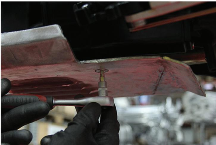
6. Setzen Sie die beiden M8-x-20-mm-Inbusschrauben samt Unterlegscheiben ein, nachdem Sie beide Befestigungslöcher ausgerichtet haben. Lassen Sie sie vorerst locker. Tipp: Gewindesicherungsflüssigkeit wird empfohlen.
